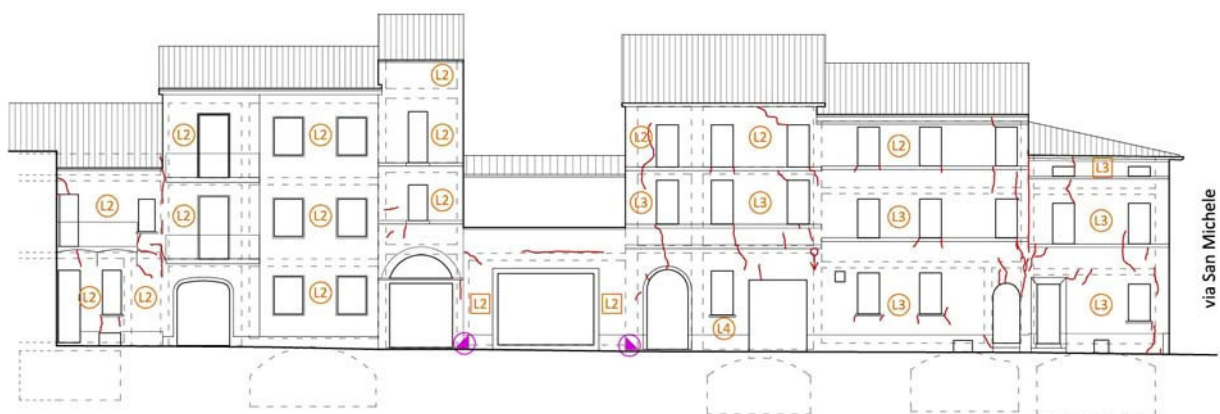
Fig.4: Rilievo critico del quadro fessurativo, prospetto su via San Giovanni Bosco.
