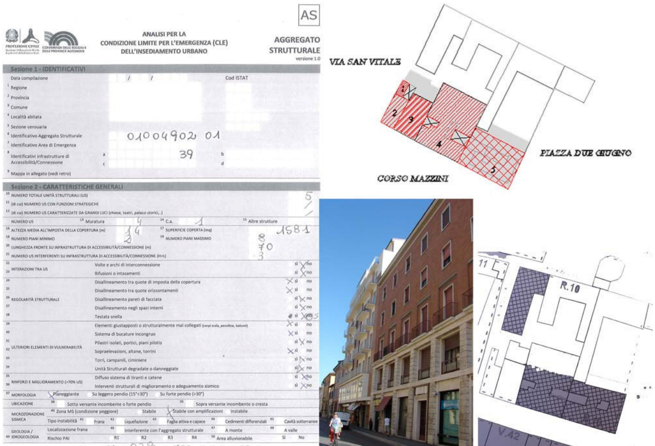
Fig.5: esempio di studio di aggregato interferente e relativa scheda compilativa.
