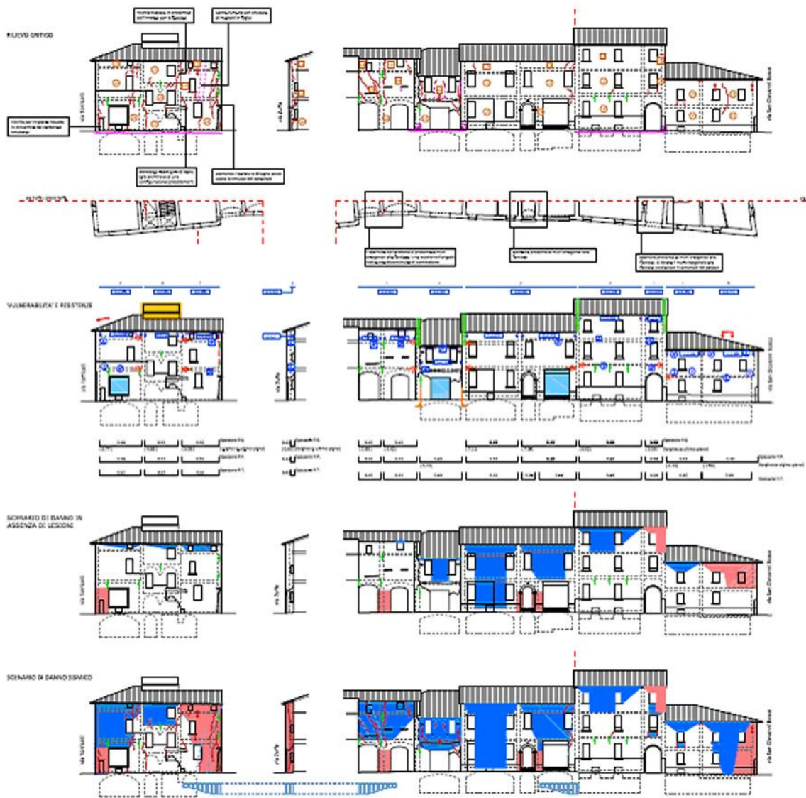
Fig.11: Analisi di un isolato campione: rilievo critico, vulnerabilità e resistenze, scenari di danno, per i fronti su via Zuffe.
