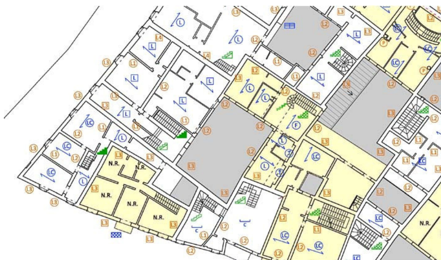
Fig.10: Presenza di solai in cemento armato e solai in legno in cellule contigue all'angolo tra via Zuffe e via San Giovanni Bosco. Nella stessa parte di aggregato è anche evidente la rilevanza dei fenomeni di sostituzione di estese porzioni edilizie (evidenziate in giallo) come conseguenza delle ricostruzioni operate dopo la seconda guerra mondiale.
