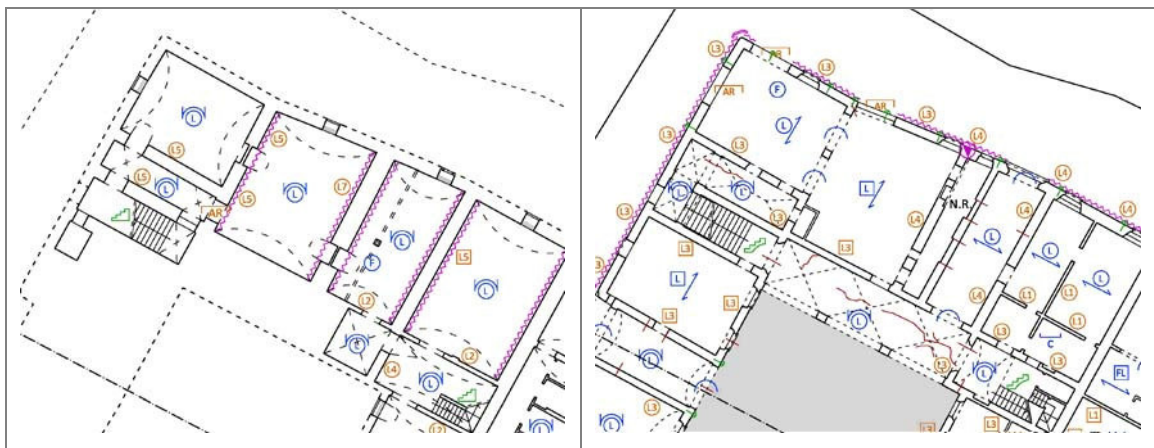
Fig.9: Pareti in falso sulle sottostanti volte dei piani interrati all'angolo tra via Torricelli e via Zuffe. Nelle due cellule d'angolo su via Torricelli si osserva inoltre la presenza di due archi spingenti contro la parete di facciata.
